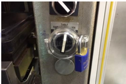
Bloqueio de chave seletora
